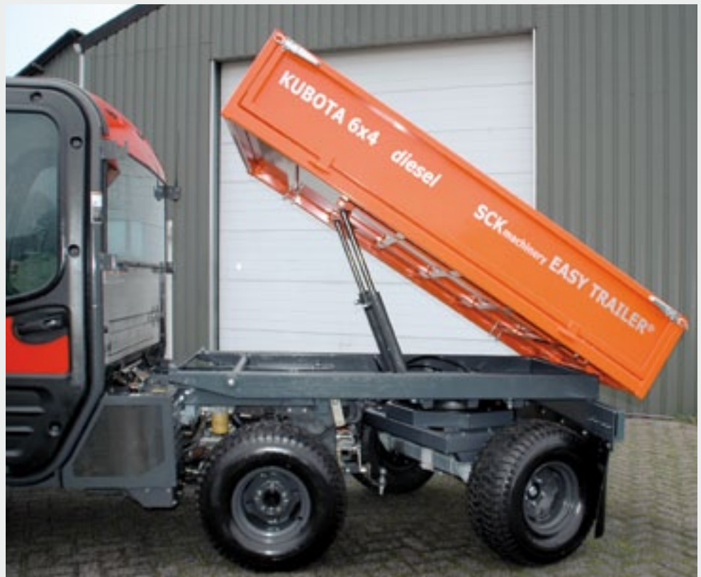
De draaischamel met de derde as zit aan een hulpframe dat verticaal scharniert aan het oorspronkelijke frame en ook kan torderen. De extra as heeft zo veel vrijheid en benadeelt de tractie niet.
