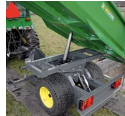
Een cardanisch gemonteerde telescoopcilinder kiept de bak. De dubbelwerkende cilinder voor de stempels zit achterop.
