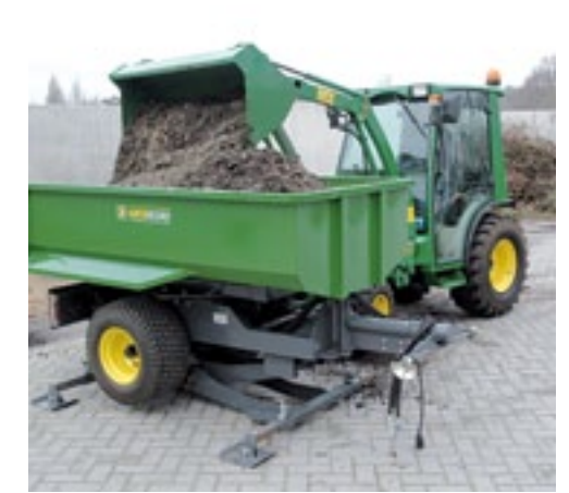
Afgekoppeld kan de wagen ook afgestempeld staan. Hierdoor staat hij mooi stabiel bij het volscheppen.
