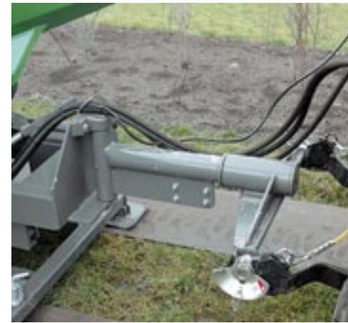
Het draaipunt van de dissel ligt midden tussen de achteras van de trekker en de as van de wagen. Hierdoor is de kar spoorvolgend.
