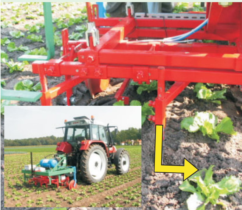
Curatieve onkruidbestrijding in de gewasrij (SarL Radis intrarijwieder).
