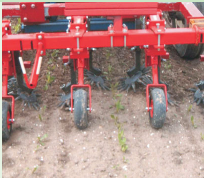
Mechanische onkruidbestrijding met een vingerwieder in witlof.
