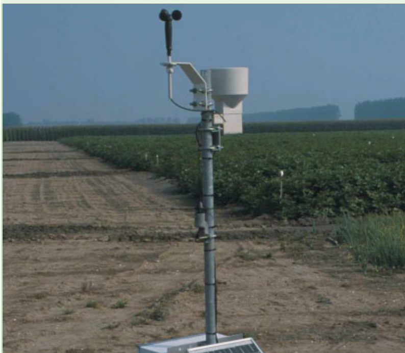
Overzicht van een praktijkproef naar doseringsverlaging. Weergegevens worden gebruikt om voorafgaande aan kritieke perioden een bespuiting te adviseren.
