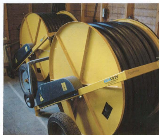
De twee haspels – met elk een lengte van 150 meter – rollen zichzelf tijdens het beregenen van de fairways door de waterdruk gedurende twee uur automatisch op.
