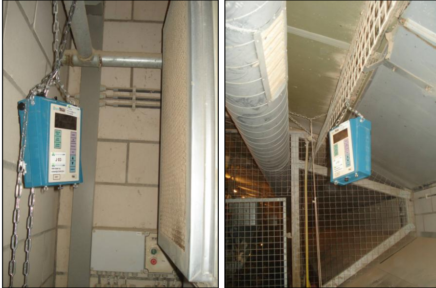
Figuur 4 Opstelling tijdens de rendementsmeting van het systeem Links: DustTrak bij de instroomopening van het systeem Rechts: DustTrak bij één van de uitstroomopeningen
