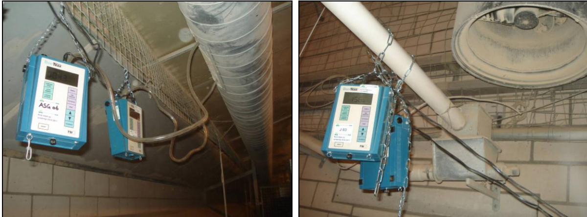
Figuur 6 Links: DustTraks met slangetjes in de uitstroomopening van het systeem Rechts: DustTraks bij de ventilatorkoker
