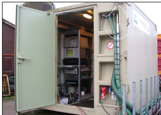
Meetshelter met injectieapparatuur, GC voor bepaling \text{SF}_6 -concentratie en multigasmonitor voor bepaling broeikasgassen en \text{NH}_3 .
