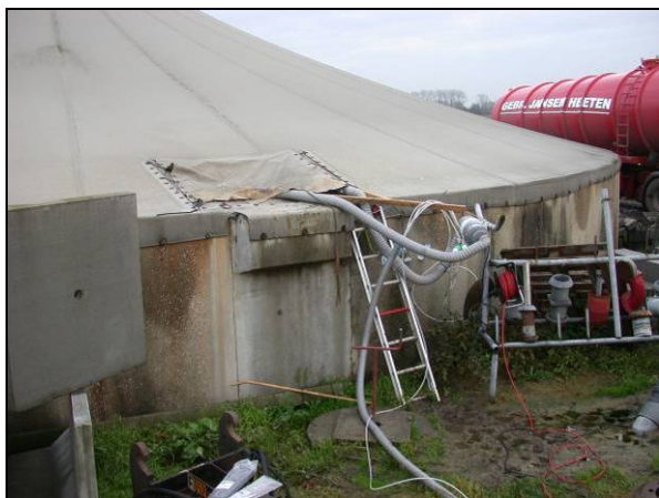
Meting mestsilo, ventilator met injectie en monsternamelingen
