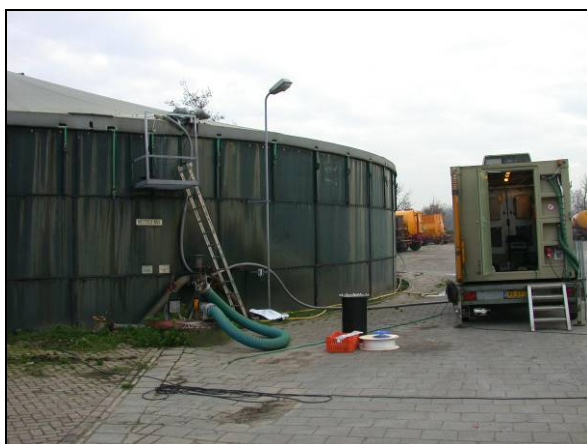
Meting mestsilo met interne tracergas ratiomethode
