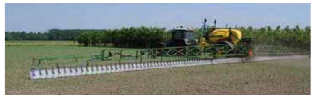
De innovatieve wingsprayer in actie: minder middel, minder drift en betere werking
