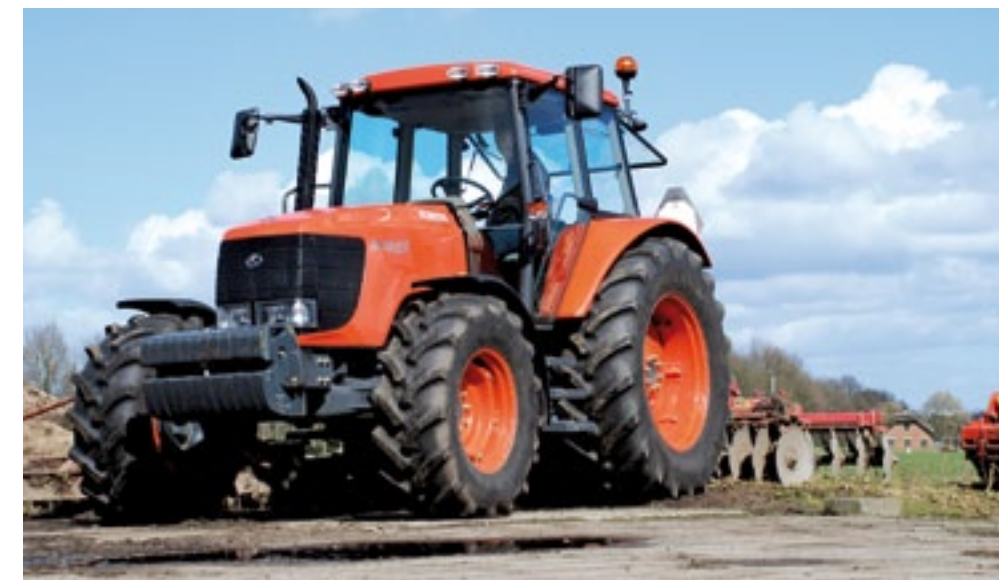
▲ De Kubota M128X was de eerste echte landbouwtrekker waar importeur de Vor in Nederland mee op de voorgrond trad. In 2009 testte LandbouwMechanisatie deze Japanner. Onze conclusie: een veelzijdige en dankzij Bi-Speed wendbare trekker, met een fijne achttraps powershift versnellingsbak.
