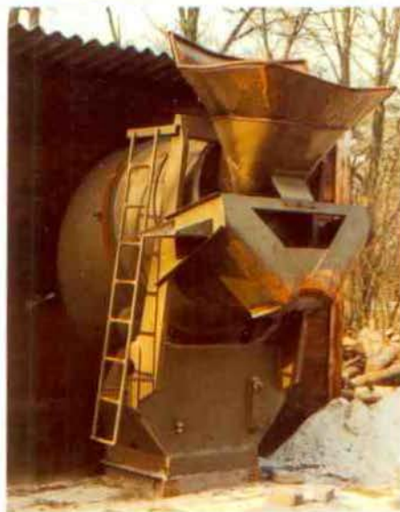
Mixer om eigen topdressing samen te stellen. Deze mixer is gebouwd uit een 2e hands mixer van een cement-truck.
