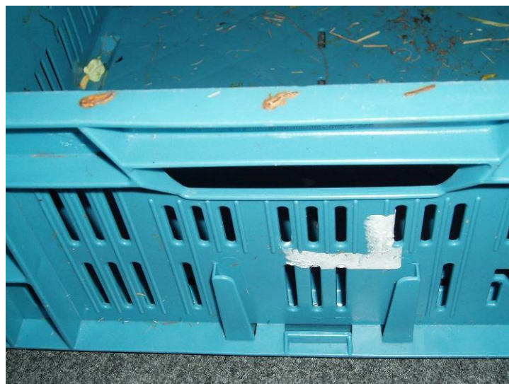
Nietjes door de bovenkant of zelfs de onderkant van het handvat komen bij groentekratten frequent voor en leiden vaak tot verwondingen
