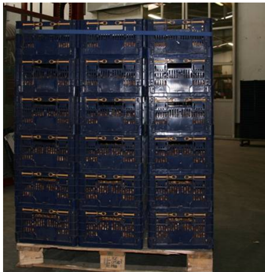
Niet in verband gestapeld fust op een pallet is met een spanband bij elkaar gehouden
