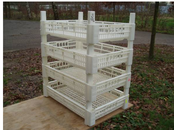
Een in- en een uitgeklapt klapkrat (links boven), nestbaar fust (rechts boven) en broeibakken die compact gestapeld kunnen worden door ze om en om te kantelen (foto's onder)
