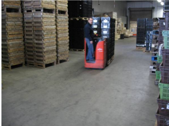
Vervoer van klein fust vanuit de koelcel naar de inpakafdeling met behulp van een aangedreven palletwagen
