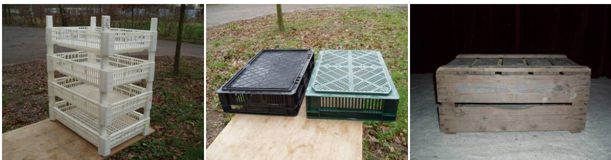
Een stapeling waarbij holtes over de onderstaande pootjes vallen (foto links) is zeer stabiel. Ook rand of een profiel aan de onderkant van het fust dat in het onderstaande fust valt (foto midden) geeft stevigheid aan de stapel. Bij fust zonder nokken of randen (foto rechts) is meer oplettendheid nodig om recht te stapelen.
