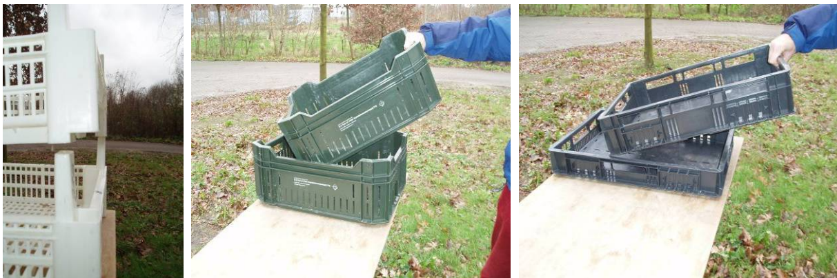
Holtes die over pootjes vallen (foto links) geven een stabiele stapel, maar zijn lastig te positioneren. Dat geldt in mindere mate voor het fust in het midden, waar het fust bij de hoeken hoger is dan aan de zijkanten. Het fust op de foto rechts schuift het gemakkelijkst naar de juiste plaats.
