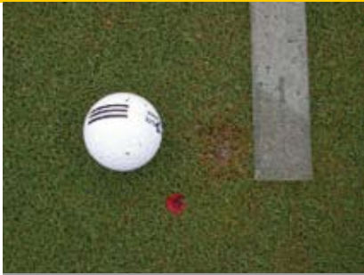
Blik op de methode die gehanteerd is om de diameter en het schadegebied van de ballmark te meten. De genummerde rode tee toont het 'treatment' en 'replication' nummer.
