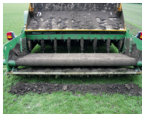
De machine schoonmaken is eenvoudig. Even de kap wegdraaien en je kunt overal goed bij. Het cilindertje tilt de kap eerst een eindje op, de rest moet met spierkracht gebeuren.
