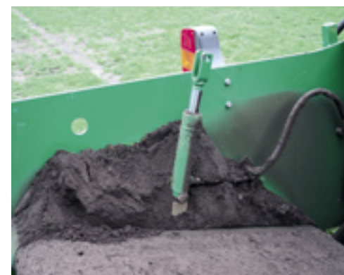
De machine schoonmaken is eenvoudig. Even de kap wegdraaien en je kunt overal goed bij. Het cilindertje tilt de kap eerst een eindje op, de rest moet met spierkracht gebeuren.
