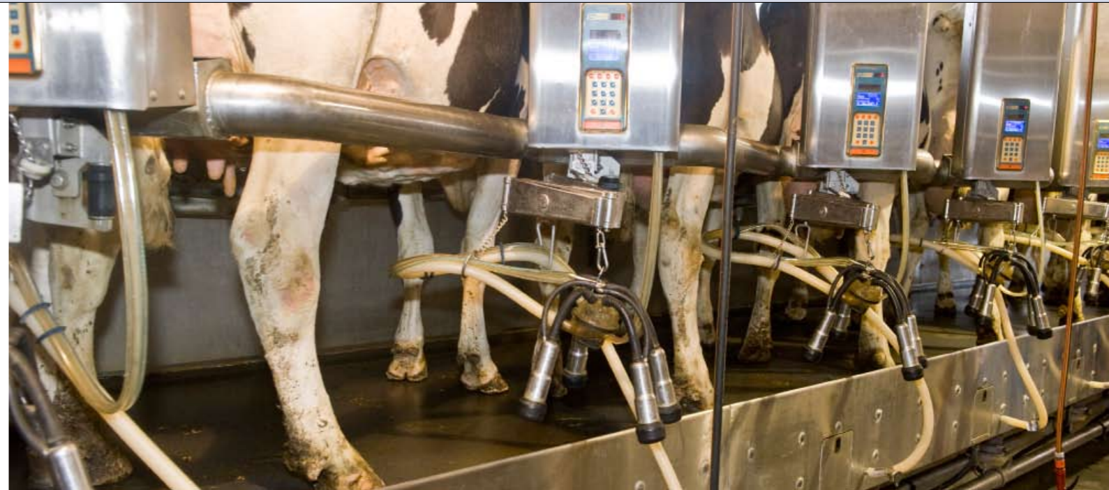
De nieuwe 2 x 8 melkstal uit roestvrij staal met arbeidsvriendelijke geleidearmen
