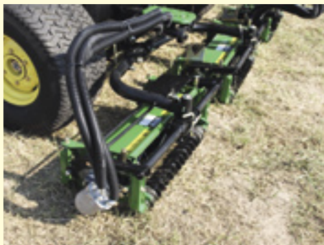
Druk op de beugels houdt de maaikooien bij de nieuwe 8400 op de grond.
