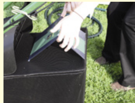
Een gaasdoek op de JX 90 handmaaiers geeft aan of de verzamelbak vol is.
