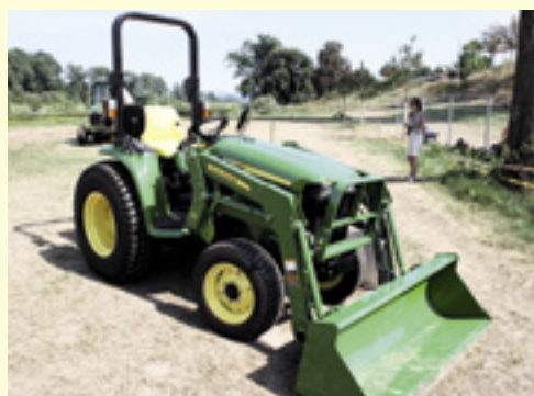
De 3036 C is hydrostatisch aangedreven en heeft weinig poespas.
