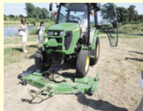
Rustig voorwaarts over het ondermaaidek: begin van automatisch aankoppelen.
