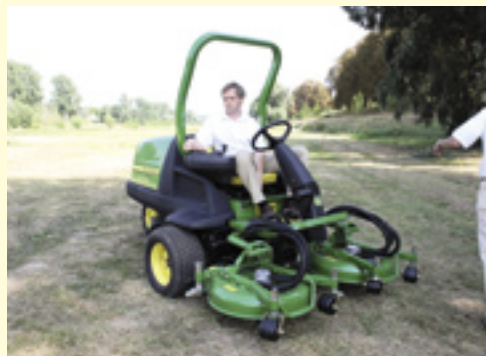
Eerst naar binnen, dan pas gaan de maaidekken van de 7400 Terrain Cut omhoog.
