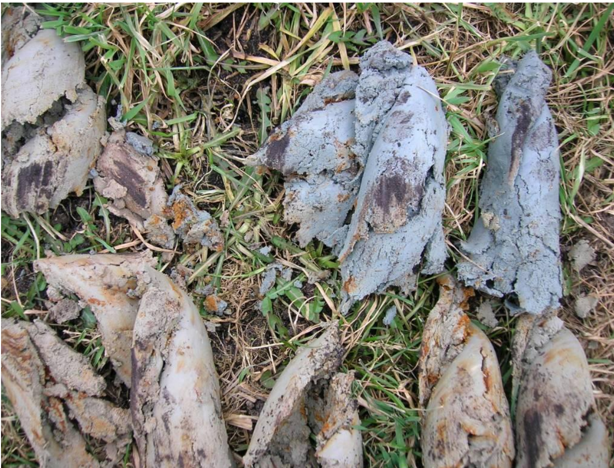
Foto 5 Een grondboring met keileem, grijze keileem met roest overgaand in gereduceerde blauwgrijze keileem
