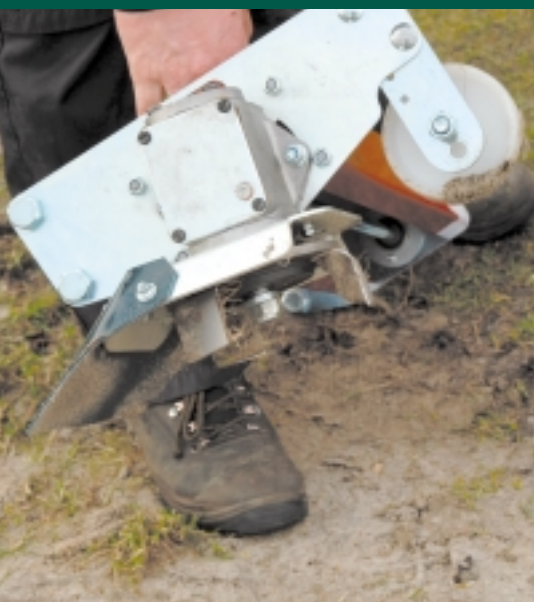
Naast een kantensnijder heeft de Hoge Dijk ook een kantenfrees gekocht bij Maredo. Deze kan met een borstel of messen worden uitgevoerd.
