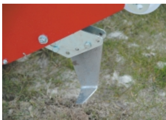
Het mes van de kantensnijder. Het mes draait niet rond als veel andere snijders, maar 'snijdt' door middel van sterk pulseren.
