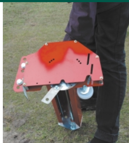
Een ander aanbouwwerktuig dat Hoge Dijk heeft gekocht: is een verticaal maaimes. Dit kan gebruikt worden om gras uit bunkerranden te maaien.
