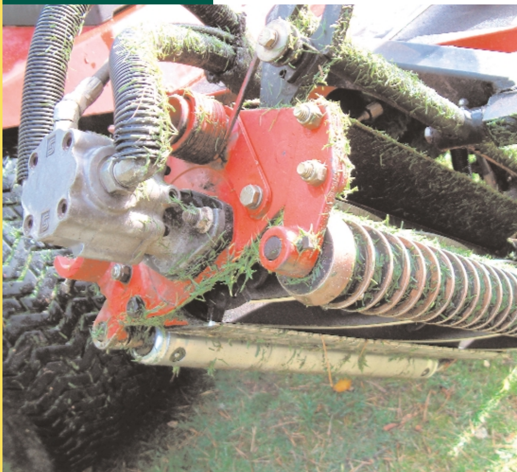
Maaierhoogte afstellen De maaierhoogte kan eenvoudig worden afgesteld met behulp van achterste rol.
