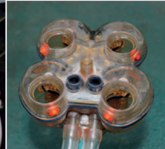
De vier aparte melkkamers zijn duidelijk te zien. Elke kamer is voorzien van een eigen luchtgat.
