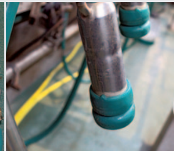
Een pijltje op de tepelvoering en uitsparing in de tepelbeker zorgen ervoor dat de tepelvoering op de juiste manier gemonteerd wordt.
