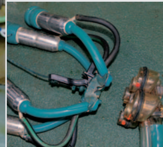
Hier zijn onder- en bovenkant gescheiden. Dit gebeurt door een schroef los te draaien. Het stel kan maar op één manier in elkaar gezet worden.
