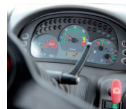
Logisch en overzichtelijk instrumentarium met stopknop en stuurverstelling. De controlelampjes mogen duidelijker.
