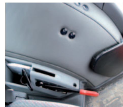
Vanaf links de 'sleutel' voor het omsteken van de aftakas van 540 naar 1.000 toeren, de handrem en de rijdersstoel.
