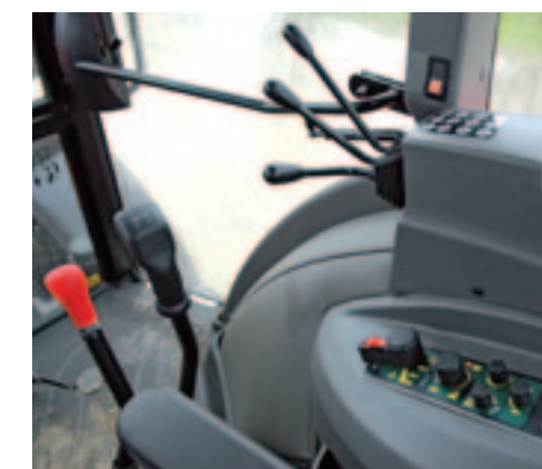
Eenvoudig maar doeltreffend. Dat geldt zowel voor de elektronische hef als de mechanische stuurventielen.
