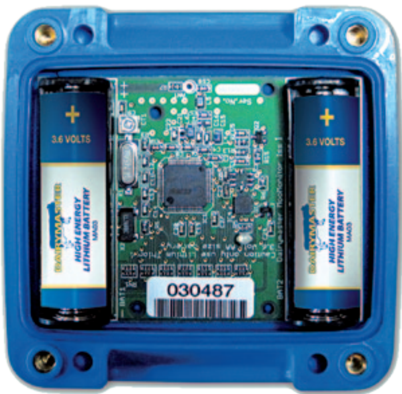
Het grote onderdeel in het midden is de processor, rechts daarvan de accelerometer van 4 bij 4 mm. De batterijen kunnen vervangen worden.
