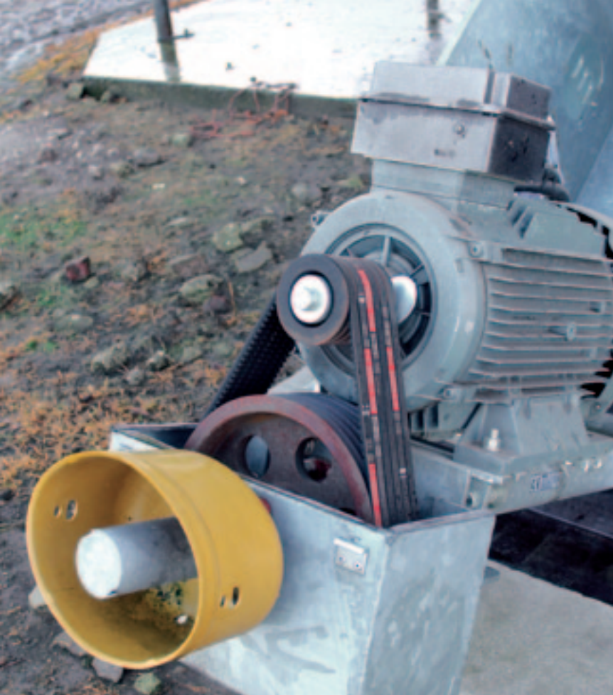
Veel elektrische propellermixers zijn nog steeds met de aftakas van de trekker aan te drijven in het geval van vastzittende mest.
