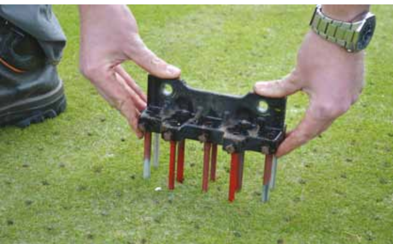
De verschillen in de pennen vormen een dilemma bij dit onderzoek: een pen die maar amper in de grond komt, zal automatisch minder snel slijten.
