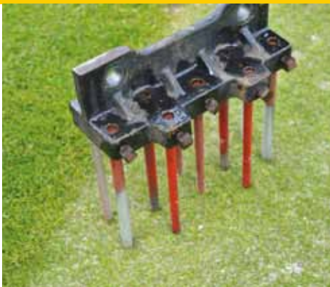
Toch verschillen in lengte en dikte van de testpennen. Daarover moeten we goed nadenken; een pen die dieper de grond in gaat zal namelijk meer slijten. We gaan dus de afname in lengte meten!
