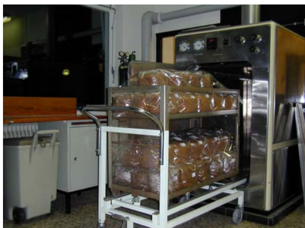
Fig. 1 Na het vullen van de zakken werd het zaagsel gesteriliseerd in een autoclaaf.
