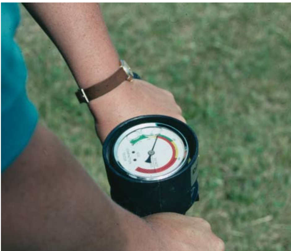
Penetrometer, een instrument, waarmee de draagkracht of stevigheid van de toplaag kan worden gemeten
