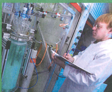
Voor productie op grote schaal wordt een computergestuurde synthesereactor gebruikt.
