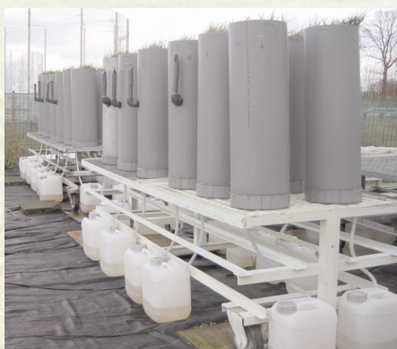
Fig. 3. De lysimeter opstelling met ongestoorde bodemkolommen van 20 cm diameter en 60 cm hoogte. Met 3 toedieningstijdstippen en 1 blanco, 2 bodems, 2 destructieve meetstijdstippen en 3 herhalingen bedroeg het totale aantal lysimeters 48. Uitgespoeld water werd opgevangen en geanalyseerd.
