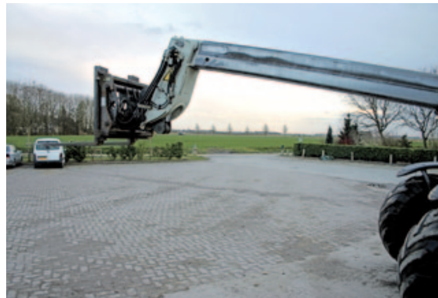
▲ De telescooparm schuift ongeveer 2,5 meter uit.
