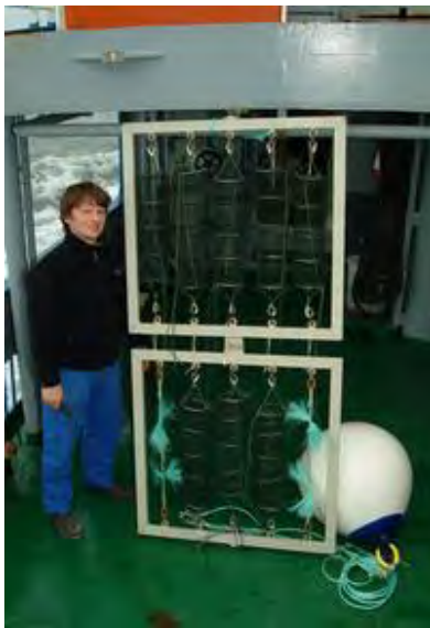
Fig. 10-24 - De mosselkooistructuur met aparte kooien in één grote vlottende kooi Belgische kooisysteem voor de offshore kweek van mosselen gebruikt door Reynaert-Versluys.
