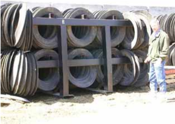
Een frame waaraan de (speciale) banden worden opgehangen en tevens worden opgeslagen
