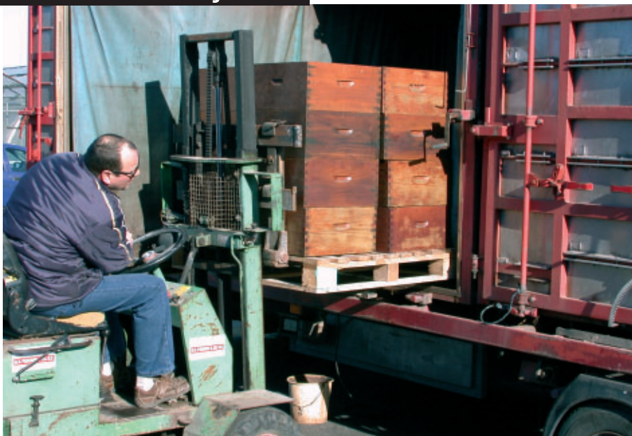
Bakken worden in stoomcompartiment gereden (foto's L. van Gelderen)
