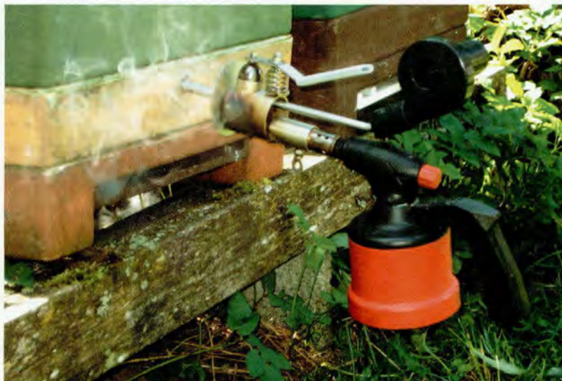
De GTM-verdamper met kleine ventilator in gebruik. Foto's: P. Elshout
