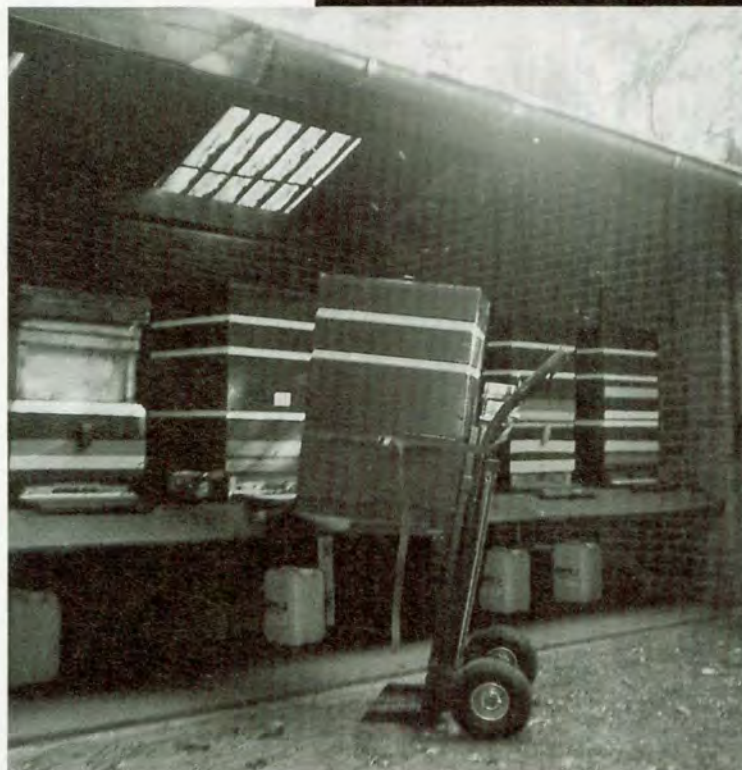
Bijenstal van dhr. J. Wieskamp uit Dinxperlo. Hij maakte een bijenkasttransporteur met een draaibaar plateau. Nu kunnen de kasten door één persoon verplaatst worden en plegen ze geen aanslag op de rug. Hij is gemaakt van een oude steekwagen.
