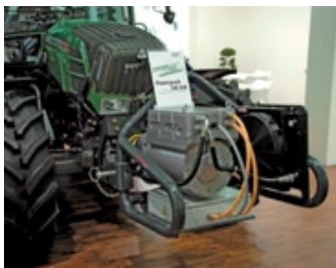
Deze generator in de fronthead komt van Sensortechnik Wiedemann. Dit bedrijf levert ook de frontgenerator van Zuidberg in Ens.
