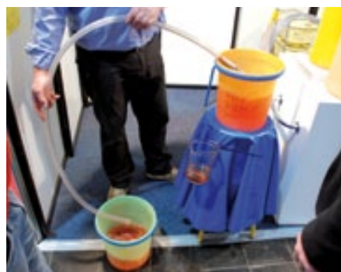
Een Duitse firma die enkel bekend is via het e-mailadres KBM1@hotmail.de importeert deze zelfaanzuigende vloeistofslang. Door het uiteinde in een hoger staande tank, emmer of kan te hangen en een schuddende beweging te maken, zuigt de slang vloeistof aan. Een terugslagklep zorgt voor blijvende werking. De slang is te koop in lengtes van 1,6 en 2,5 meter met een grof of fijn filter. De 1,6 meter versie met grof filter kost 18 euro.
