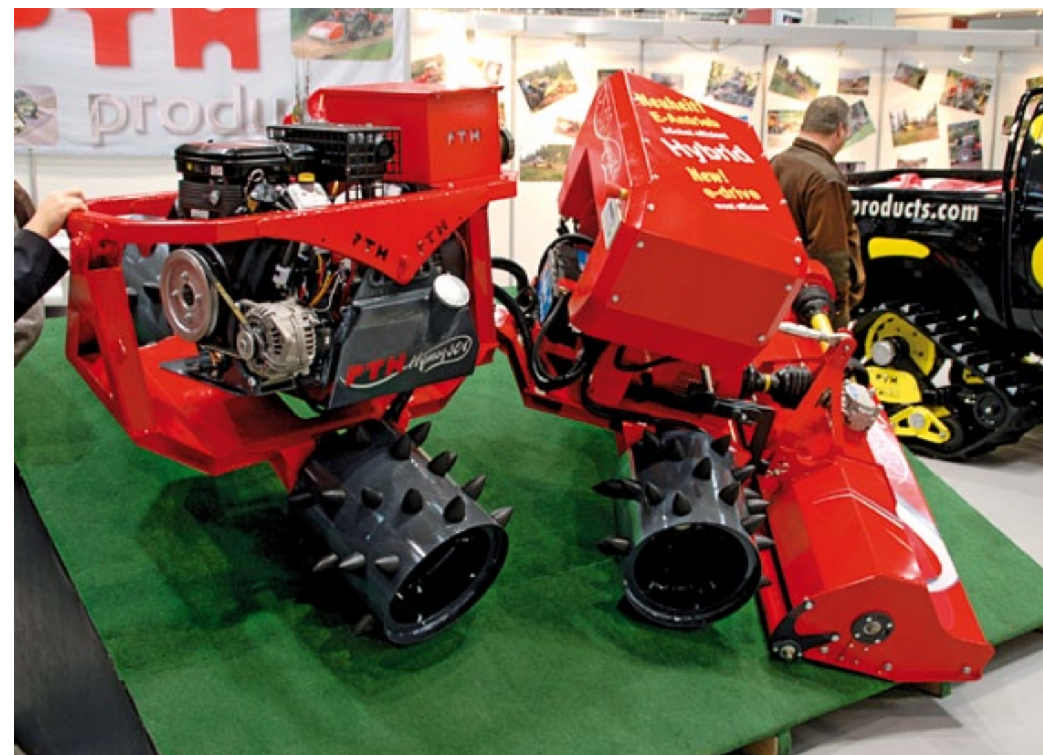
Het is nog een prototype, maar deze radiografisch bestuurd taludmaaier luisterend naar de naam PTH komt begin volgend jaar op de markt. Bijzondere kenmerken zijn de knikbesturing en de hybride aandrijving: een 23 pk B&S drijft een generator aan, die op zijn beurt weer elektromotoren voor de wielaandrijving voedt. De snelheid is traploos regelbaar van 0-7 km/h en de klepelmaaier heeft een werkbreedte van 135 cm. De prijs ligt rond 30 mille.
