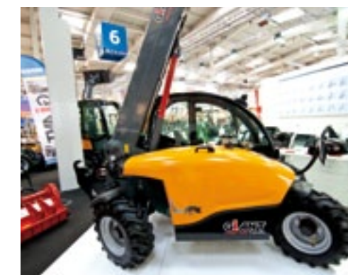
Na minishovels bouwt het Nederlandse Tobroco nu ook de Giant miniverreiker. De 4548 Tendo heeft een Kubota viercilindermotor van 33 kW (45 pk). Met hydrostatische aandrijving rijdt hij maximaal 20 km/h. De hefhoogte bedraagt 4,80 meter, de hefkracht is 1.400 kg. De machine weegt 2.950 kg, is 1,95 meter hoog en 1,60 meter breed. De Tendo kost 42.000 euro en krijgt er naar verwachting een broertje bij dat 2.500 kg tilt.
