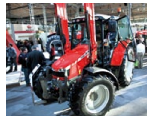
Na de vier kleine modellen uit de Massey Ferguson 5400-serie zijn nu ook de twee kleinste modellen uit de 6400-serie, de 6445 van 70 kW (95 pk) en 6455 van 77 kW (105 pk), te krijgen met de nieuwe schuine neus. Dat geeft bij deze viercilindertrekkers vooral meer zicht op frontwerktuigen. De 6400-trekkers hebben een versnellingsbak met een zestraps powershift.
