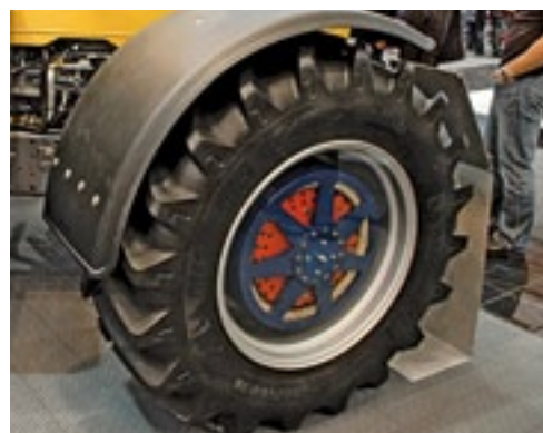
Rigitrac monteert op de EWD 120 elektrische wielmotoren. Een generator aan de diesel zorgt voor de voeding, ook voor werktuigen.
