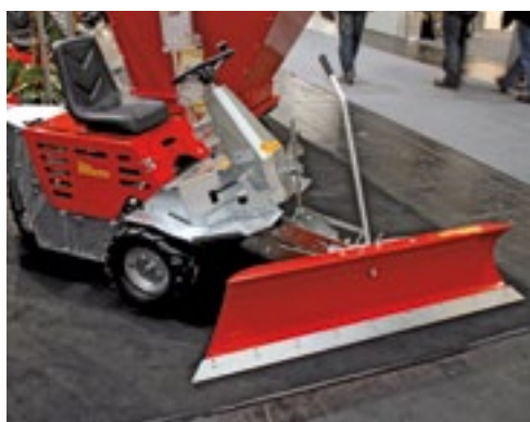
Westermann uit het Duitse Meppen toonde deze 180 cm brede links of rechts werkende sneeuwschuif voor bevestiging aan zijn driewielige werktuigendrager. Deze CM2 heeft hydrostatische aandrijving en wordt naar keuze geleverd met een Hatz diesel- of Honda benzinemotor. De CM2 is 77 cm breed en weegt 220 kg. Aan het snelwissel-frame is een groot scala aan werktuigen te bevestigen.
