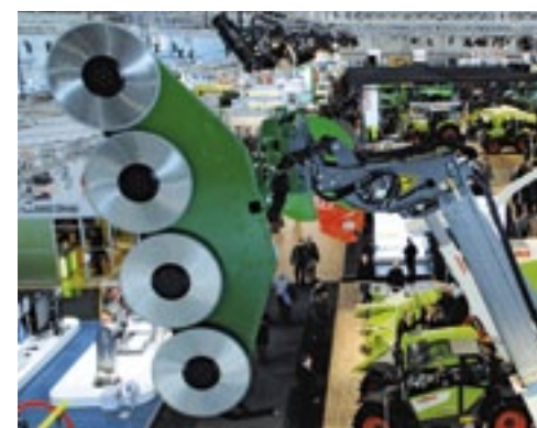
De nieuwe LRS 1601 boomzaag met vier zaagbladen van 40 cm vult Spearheads pakket van twee boomzagen aan de onderkant aan. De zagen zijn hydraulisch aangedreven en zagen takken van 5 mm tot 12 cm. De nieuwe LRS kan gebruikt worden met alle Twiga's van Spearhead, zowel met de armen als met de tevens nieuwe Twiga HXF 2800 die aan een voorlader, shovel of verreiker wordt gekoppeld.
