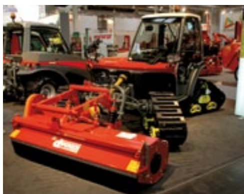
Rupsen in allerlei maten en soorten dringen op weinig draagkrachtige gronden geleidelijk aan de lagedrukband naar de achtergrond. Deze Aebi TT240 met een Ducker klepelmaaier is voorzien van rupsen van PTH. Op de Nederlandse markt is Westtrack een bekende speler. Dit bedrijf kwam onlangs in handen van Zuidberg in Ens, de bekende fabrikant van frontheadinrichtingen.
