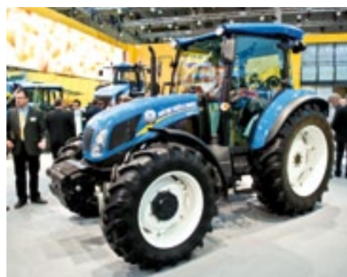
New Holland introduceerde de nieuwe T5. De drie trekkers uit deze serie hebben een motorvermogen dat varieert van 73 tot 84 kW (99 tot 114 pk). Ze halen dat uit een 3,4 liter viercilindermotor met turbo en commonrail inspuiting. De hef tilt doorgaand en op 61 cm achter de kogels 2.900 kg. Een traploze transmissie wordt in 2013 leverbaar.
