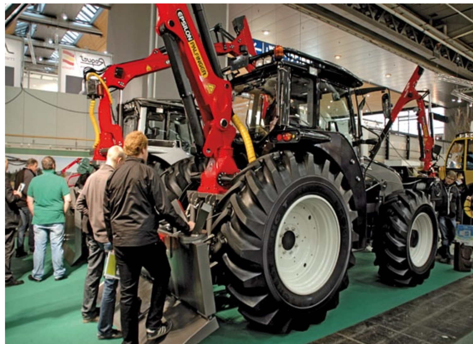
Deze Epsilon Palfinger kraan van het type M70R achterop een Valtra T171 lijkt op het eerste oog weinig bijzonder. Een nadere bestudering leert dat de Zweedse leverancier KTS de cabine van de trekker een halve meter voren plaatste om de Palfinger op de achteras te kunnen monteren. Dat geeft net als Pfanzelt in Rettenbach dat doet een hoge mate van stabiliteit bij het bosbouwwerk. De Valtra heeft een motorvermogen van 135 kW/185 pk.
