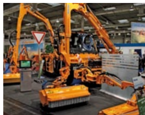
Mulag liet mooi zien waartoe ze zich op basis van een Unimog in staat acht. Dankzij automatisch hoogtevoering kan één persoon drie maaïarmen aan. De fabrikant geeft daarbij wel aan dat die persoon dan eigenlijk niet meer chauffeurs kan. Dat moet een ander doen. Wil je toch met één man werken, dan zijn twee armen de betere oplossing.
