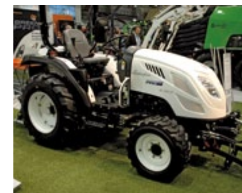
Lamborghini greep de Agritechnica aan om zijn GreenPro voor het voetlicht te brengen. De serie bestaat uit zes modellen die luisteren naar de namen G.23H, G.27H, G.30H, G.35H, G.40H en G.50H. De motorvermogens, uitgedrukt in pk, komen (dat zal u niet verbazen) nagenoeg met deze aanduidingen overeen. De driecilinder voor de drie lichte typen komt van Mitsubishi; de viercilinder voor de drie 'zware' modellen van Perkins.
