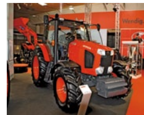
Kubota toonde een prototype van de 100 kW (136 pk) sterke M135GX in Amerikaanse uitvoering. Later volgt nog een M110GX. Kubota voldoet met een partikelfilter aan de Stage 3b-eisen. De ureumvloeistof AdBlue hoeft er dus niet in. De trekker heeft een geveerde vooras en is naar verwachting vanaf juli 2012 ook in een Europese versie te koop. De motor is een 6,1 liter zescilinder en de transmissie heeft een achttraps powershift.
