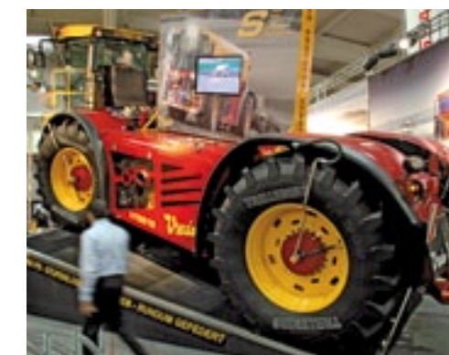
Fabrikant Vredo uit Dodewaard had best wel stoerder uit mogen pakken met de nieuwe Trac, ondanks dat het nog een prototype is. Met vierwielaandrijving en -besturing, geveerde assen, 900/60R42 banden (215 cm hoog), een traploze transmissie van Mali en een 404 kW (550 pk) Deutz mag deze 'heavy Dutchman' zich op alle fronten laten zien. Door z'n lage zwaartepunt is hij ook nog vergaand hellingproof.
