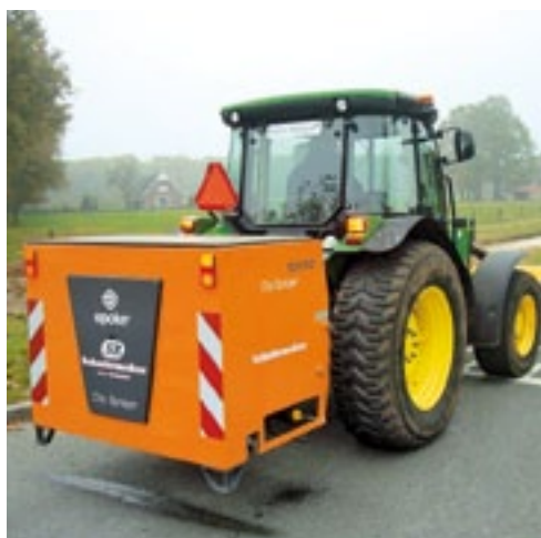
Sproeisystemen zijn in allerlei uitvoeringen. Met name voor de groenvoorziening kan een driepuntssysteem zoals deze Epoke CitySprayer een praktische oplossing zijn.
