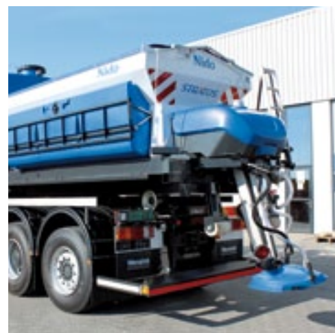
De gemeente Staphorst werkt sinds vorig jaar met een systeem van Nido dat alles in huis heeft. Droog of nat strooien, maar ook alleen pekelsproeien behoort tot de mogelijkheden.
