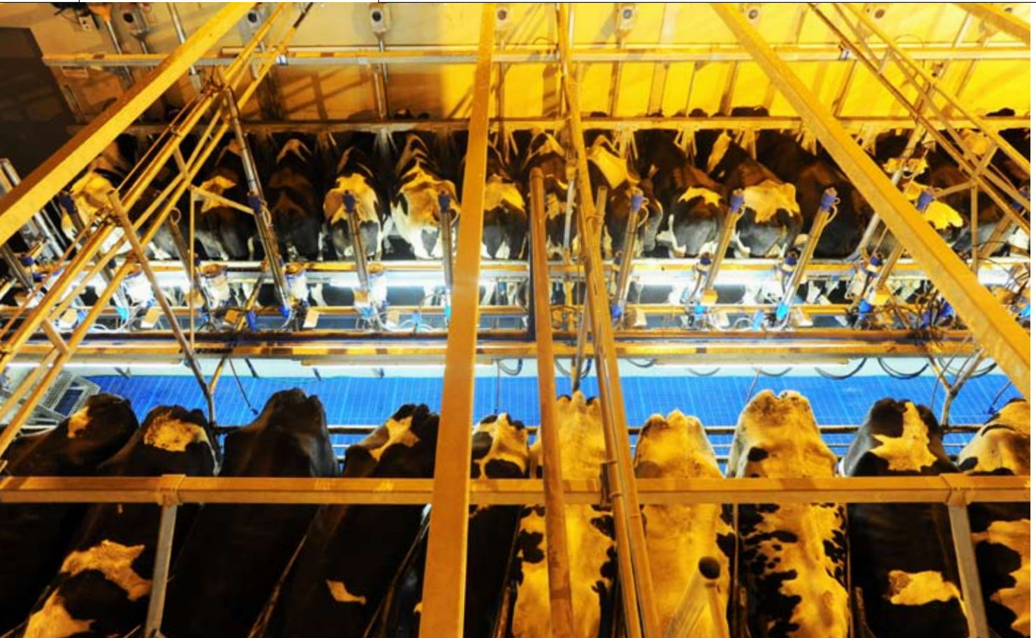
Met de 2 x 22-stands swingovermelkstal met koeherkenning en elektronische melkmeting zijn 130 koeien per uur te melken
