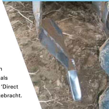
De kromme cultivatortand van de paragrubber tilt de grond op en breekt die, zonder te keren of te mengen.
