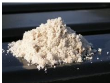
STRUVIET (LINKS) UIT HET PHOSPAQ PROCES BIJ WATERSTROMEN OLBURGEN (RECHTS)
