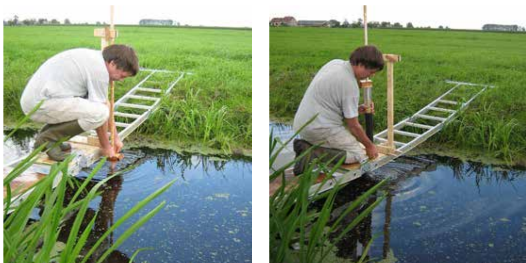
Figuur 8 Het steken van de waterbodembodemmonsters.
