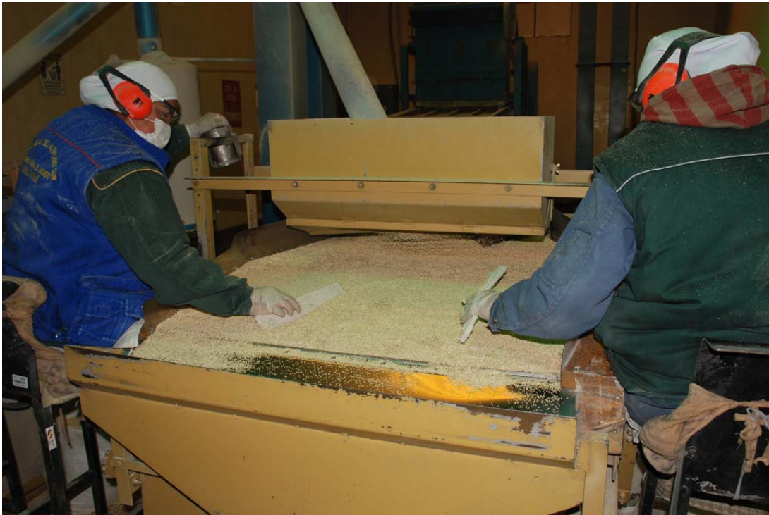
Foto 60. Separación densimétrica de impurezas de quinua en la planta de ANAPQUI, Challapata (fuente: el autor)
