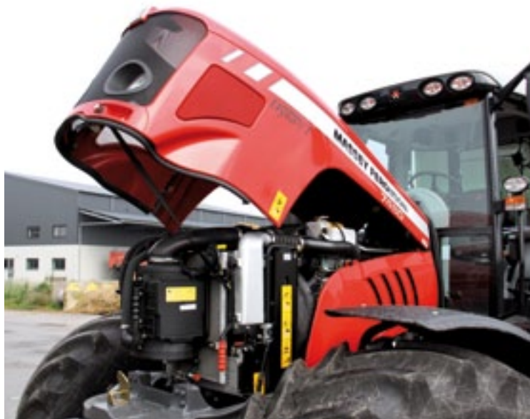
▲ De motorkap gaat niet als één geheel open, maar de kleine zijpaneeltjes links en rechts zijn snel te verwijderen. Het pakket koelers in de neus laat zich moeiteloos uitvouwen, waarna het schoonmaken makkelijk is.
