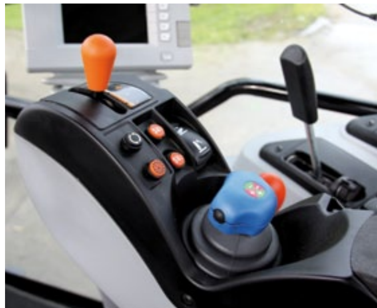
▲ De rechterarmleuning van de stoel herbergt (links boven op de foto) onder meer het pookje van de Dyna-VT en (in de Datatronic-versie) de joystick van de hydrauliek, waarmee twee van de drie DW-ventielen te bedienen zijn.
