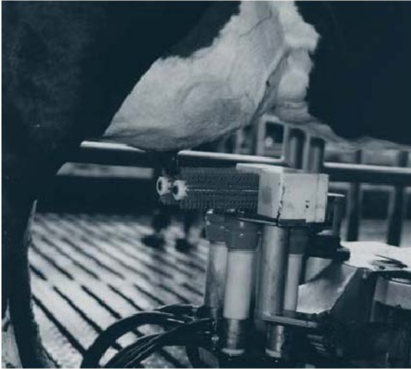
Speenreiniging bij automatisch melken met borstels.
