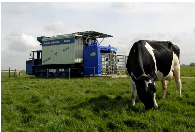
De mobiele melkrobot 'De Natureluur' geeft nieuwe mogelijkheden voor beweiding door het Automatisch Melksysteem naar de koeien te brengen.
