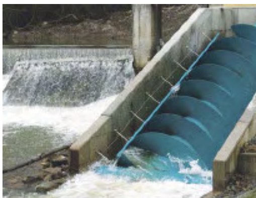
Figuur 1.1 Impressie waterkracht door vijzel
