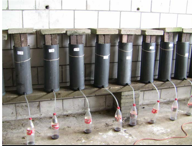
Afbeelding 3 Opstelling van proefsilos voorzien van opvang van perssap
