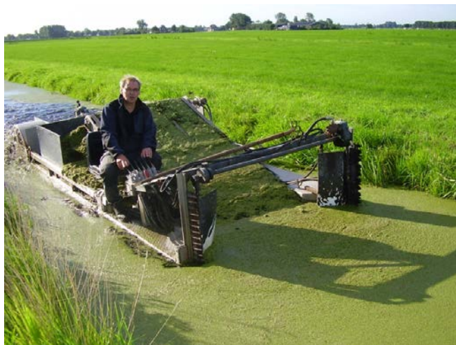
Afbeelding 1 Maaiboot van Potenger uit Wilnis speciaal uitgerust voor het oogsten van kroos
