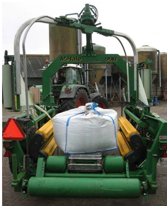
Afbeelding 7 Het in folie wikkelen van bigbags gevuld met kroos
