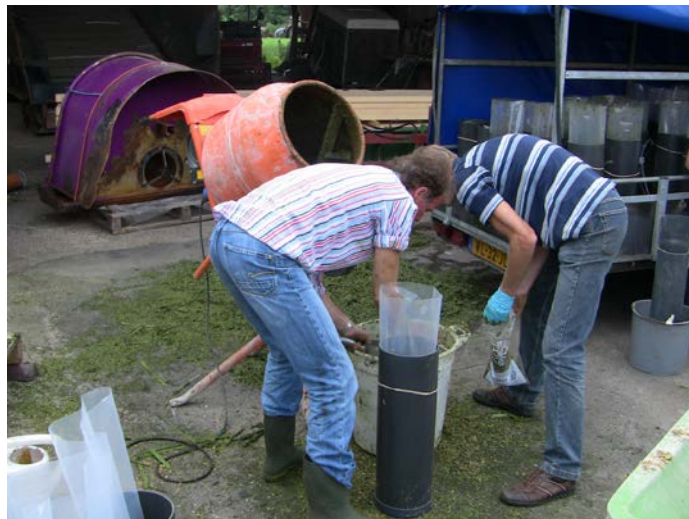
Afbeelding 5 Het vullen van proefsilos met kroos voor het conserveringsonderzoek
