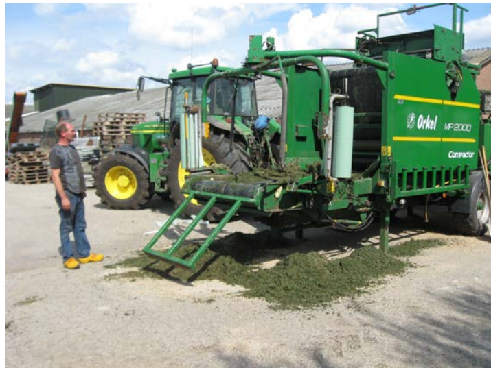
Afbeelding 4 Apparatuur voor het persen en in folie wikkelen geschikt voor relatief kleine hoeveelheden product (loonwerker Termaat uit Putten)
