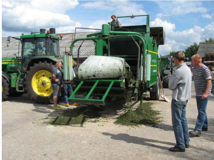
Afbeelding 6 Door de slechte structuur van het kroos was het persen en wikkelen van een ronde baal niet mogelijk
