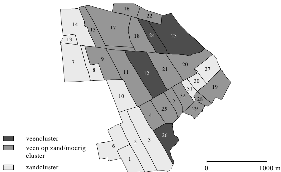
Fig. 12 Schematisatie van polder De Putten in clusters voor de bodemberekeningen
