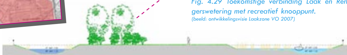
Fig. 4.30 Doorsnede landschappelijke inpassing bedrijventerrein Haarbrug-Zuid (boven) en referentiebeeld beplanting (rechts): forse beplante eilandenreeks, die de industrie aan het landschap (en oog) moet onttrekken. (beelden Ontwikkelingsvisie Laakzone, VO 2007)
