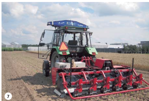
5. Robocropdetail. Door uitsparing in de disc optimale onkruidbestrijding in de rij.
