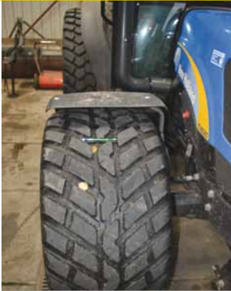
De New Holland 4020 staat op brede banden met een druk van 0.8 bar. Vanwege de geringe bodemdruk durft Maarten er goed mee over de velden en kan hij hiermee ook in het natte seizoen goed bladruimen.
