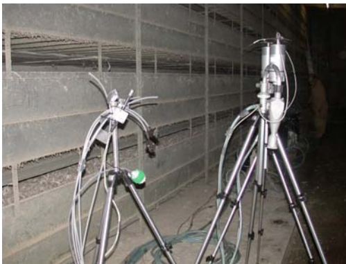
Meetpunt B, uitgaande lucht droogtunnel (links zichtbaar op de foto) ofwel de ingaande lucht van de waterwasser. Opstelling op de grond, meting van de lucht aan de onderkant van de wasser
