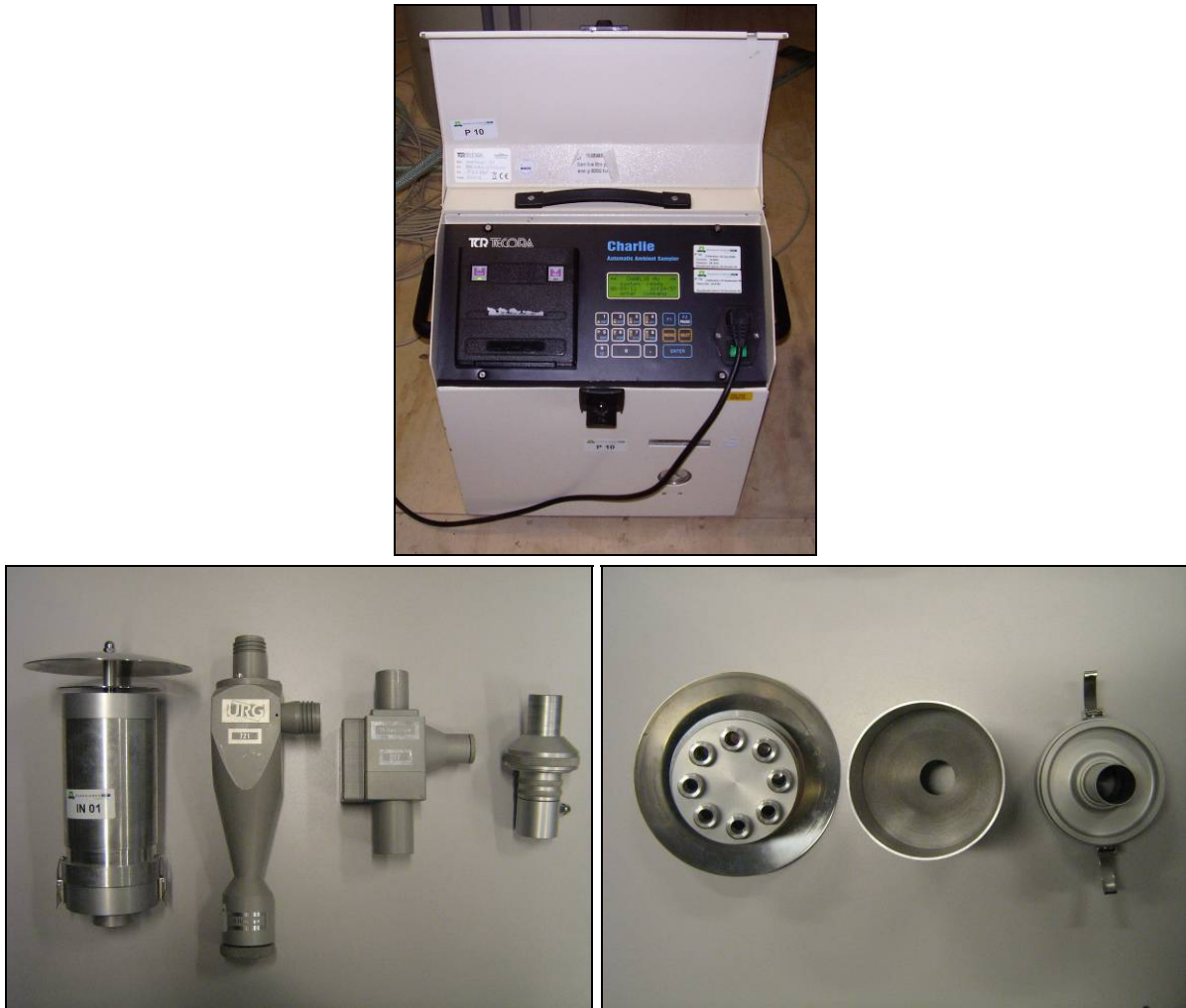
Figuur 4 Monsterapparatuur voor PM10 en PM2,5. Boven: de 'constant flow' monsternamepomp. Linksonder (van links naar rechts): inlaat, PM10 cycloon, PM2,5 cycloon en filterhouder. Rechtsonder (van links naar rechts): de constructie van de inlaat.
